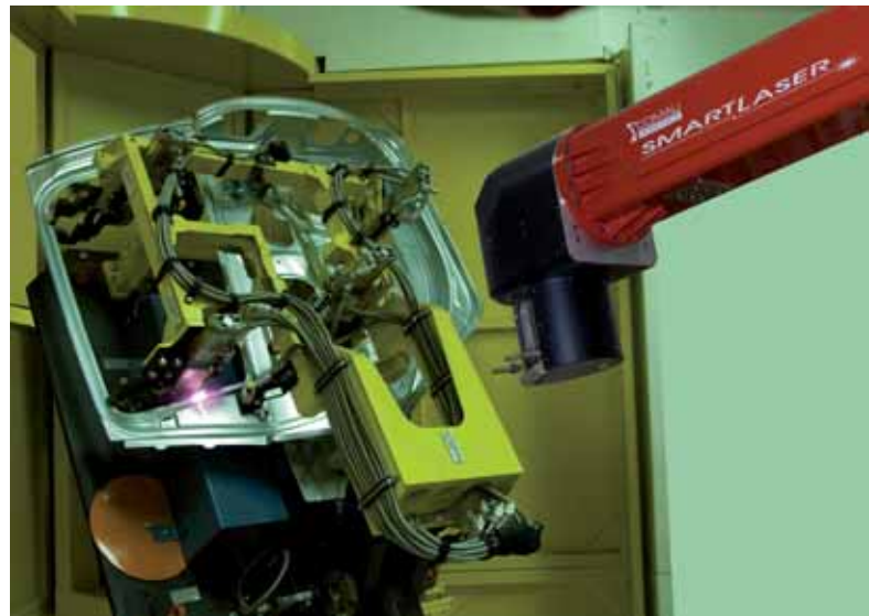
SmartLaser di Comau è un robot composto da un sistema di laser remoto 3D completamente integrato con un robot 'NJ' e basato sul know-how dell'applicazione AgiLaser.
