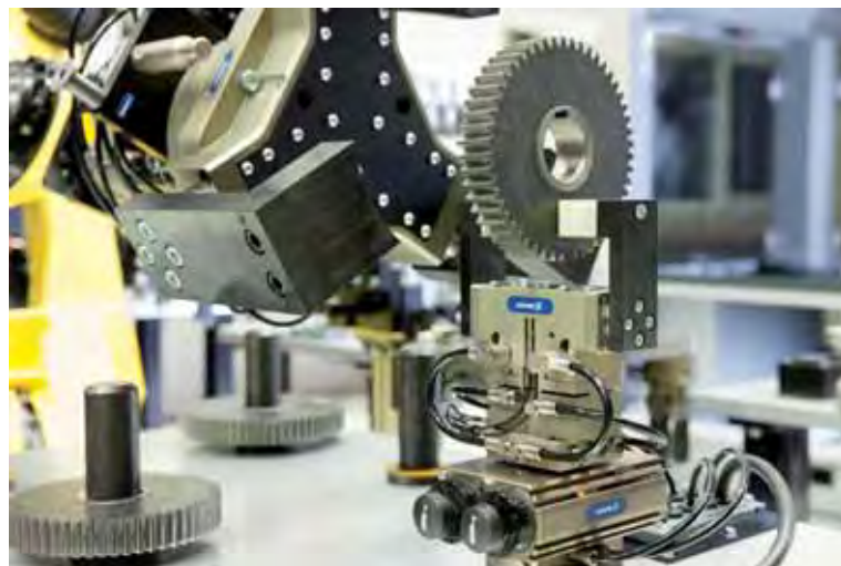
A sinistra, le pinze multiple Schunk con unità di compensazione scorrevoli. A destra, produzione di ruote dentate: le pinze ermetiche Schunk DPG-plus e DPZ-plus.
