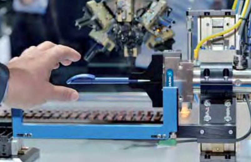
A sinistra, il sistema di presa Safety Schunk. A destra, il braccio Schunk Powerball Lightweight Arm LWA 4P mobile.
