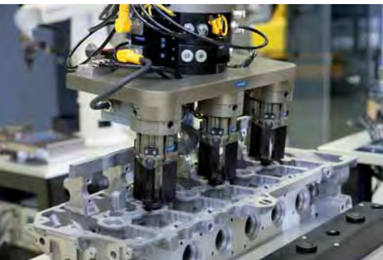
A sinistra, le pinze multiple Schunk con unità di compensazione scorrevoli. A destra, produzione di ruote dentate: le pinze ermetiche Schunk DPG-plus e DPZ-plus.
