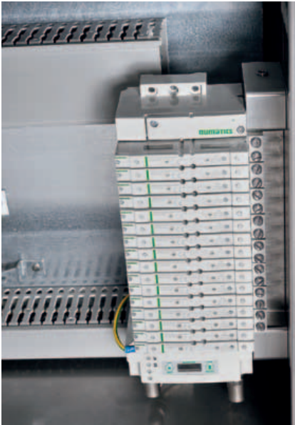
Charm 580 si interfaccia con le isole di valvole della serie 500 Asco Numatics.
