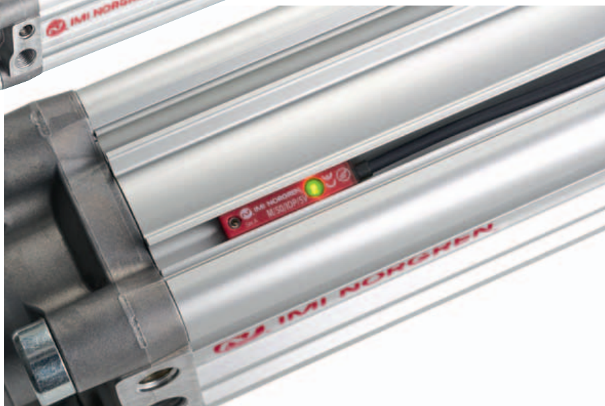
Il nuovo interruttore IMI Norgren M/50/IOP integra un indicatore LED arancione, che semplifica l'installazione in relazione al magnete del cilindro, mentre un altro LED verde indica se il dispositivo è acceso (funzione 'power-on').
