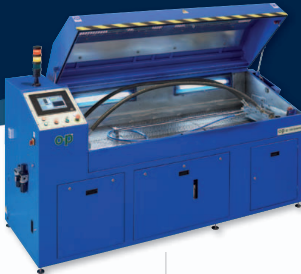
Banco ad olio o acqua fino a 2000 bar con moltiplicatore pneumo-idraulico
