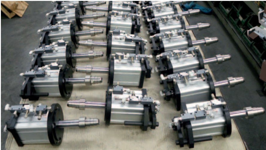
Cilindro speciale compatto a doppio effetto realizzato da Bonesi Pneumatik per Comes.
