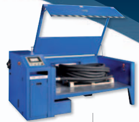
Banco per matasse fino a 800 bar con moltiplicatore pneumo-idraulico
