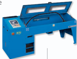
Banco di collaudo fino a 1200 bar con controllo automatico con PLC e moltiplicatore oleodinamico
