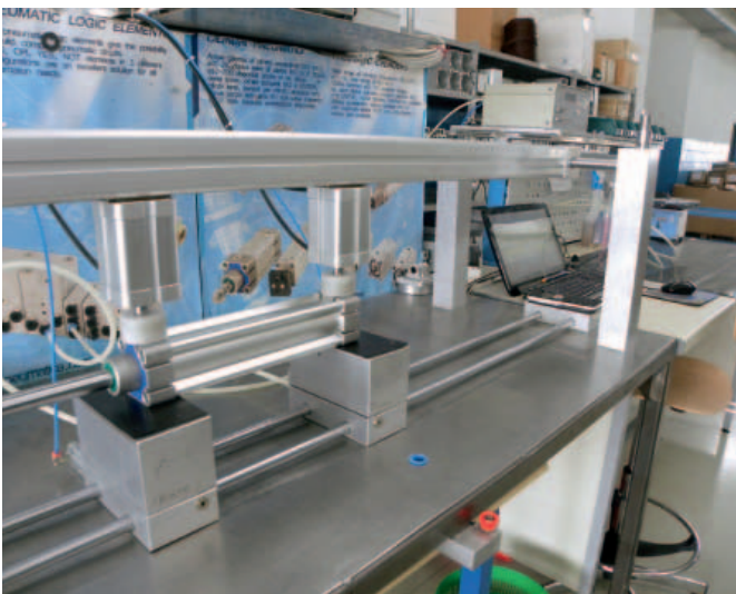
Collaudo e prove a fatica dei cilindri e valvole pneumatiche.
