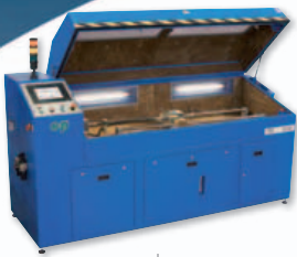
Banco per prove distruttive fino a 4500 bar con moltiplicatore pneumo-idraulico
