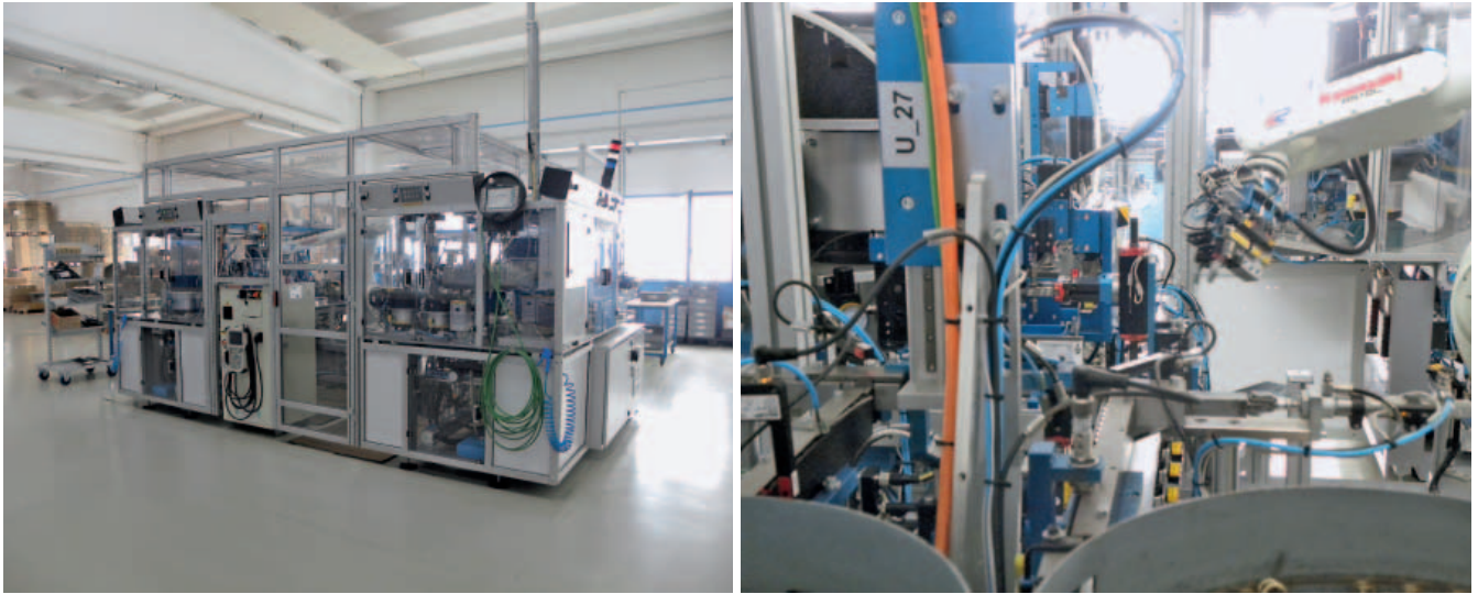
Sistema di assemblaggio automatizzato per valvole e microvalvole con robot antropomorfo.
