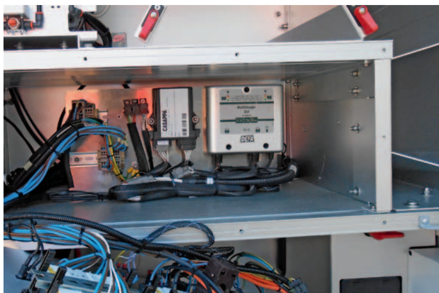
Centralina elettronica per la gestione della componentistica oleidraulica.
