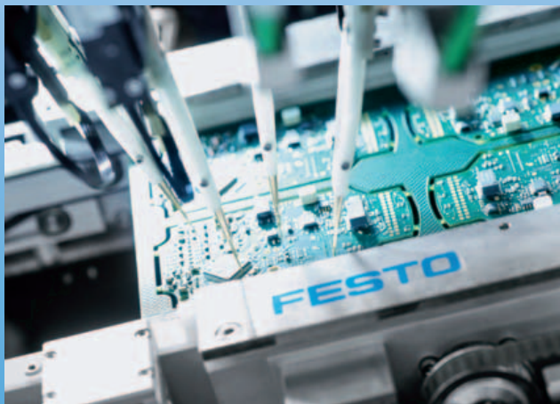
Una fase di testaggio elettronico e un sistema di attuatori Emca.
