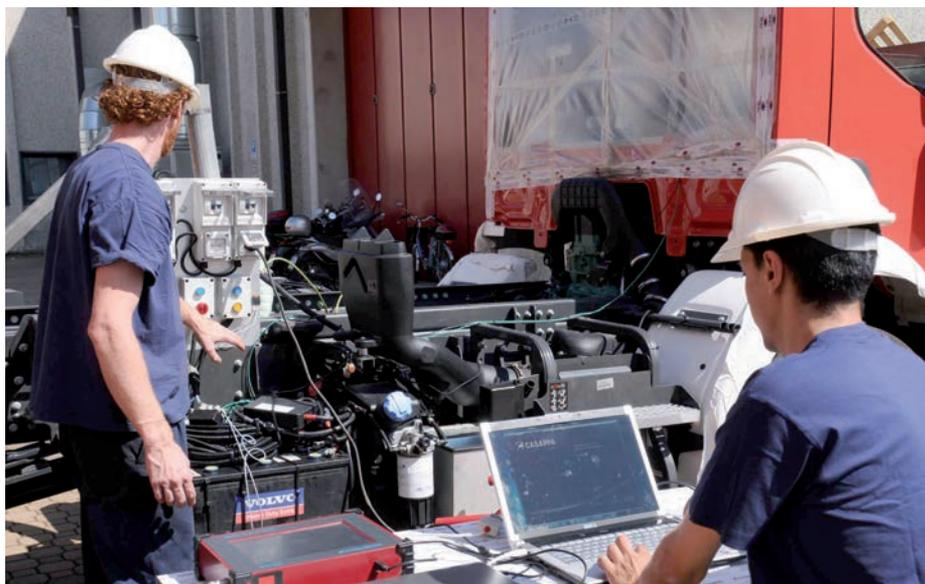
Test di messa a punto del sistema oleidraulico Casappa.
