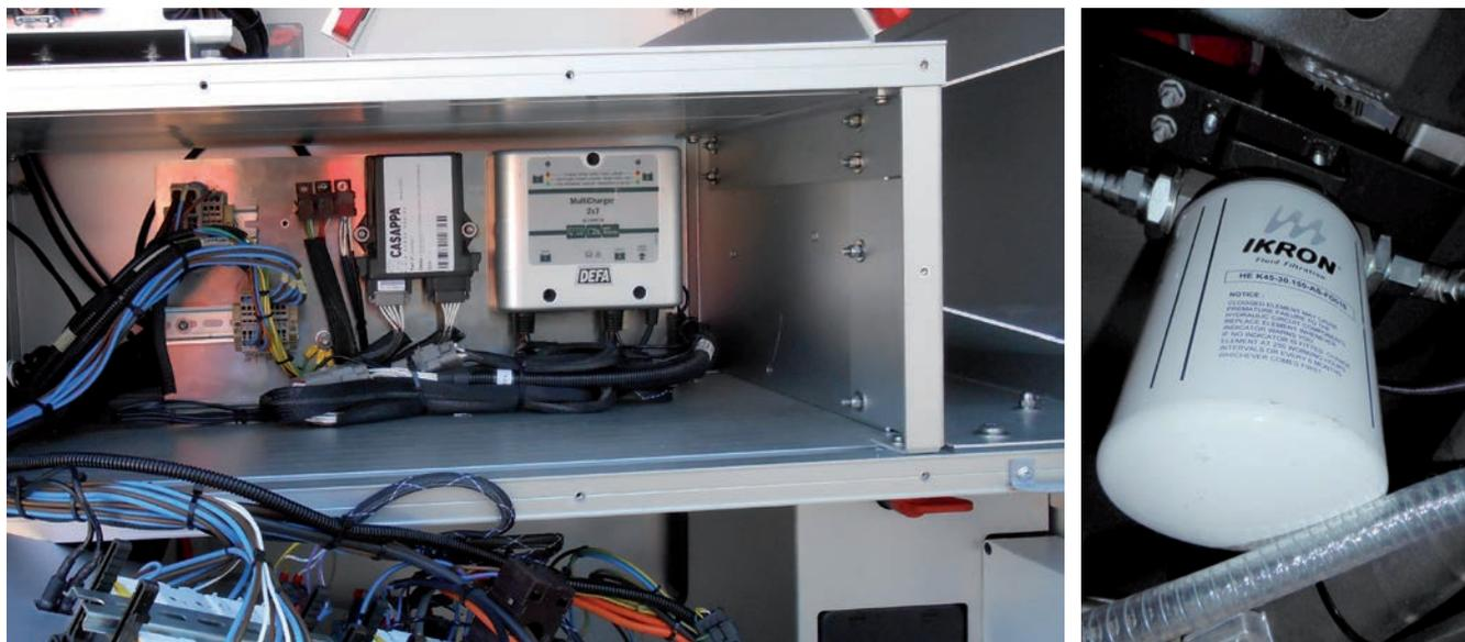
Centralina elettronica per la gestione della componentistica oleoidraulica e filtro oleoidraulico Ikron.
