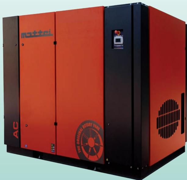
I compressori AC serie 4000 della Mattei sono dotati della valvola di aspirazione proporzionale modulante che permette un'erogazione dell'aria a pressione costante e la possibilità di lavorare anche in assenza di serbatoio.
