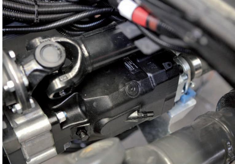
Motore oleidraulico a cilindrata fissa Casappa, equipaggiato con sensore di velocità e una pompa a pistoni a cilindrata variabile con controllo elettronico della cilindrata.
