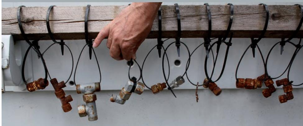
A sinistra, un raccordo per tubi Voss Fluid; a destra, raccordi utilizzati per test comparativo di corrosione.
