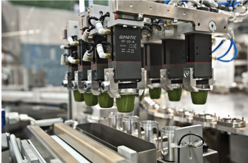
La manipolazione delle capsule avviene con pinze Gimatic XP20-A, adatte per l'industria alimentare.
