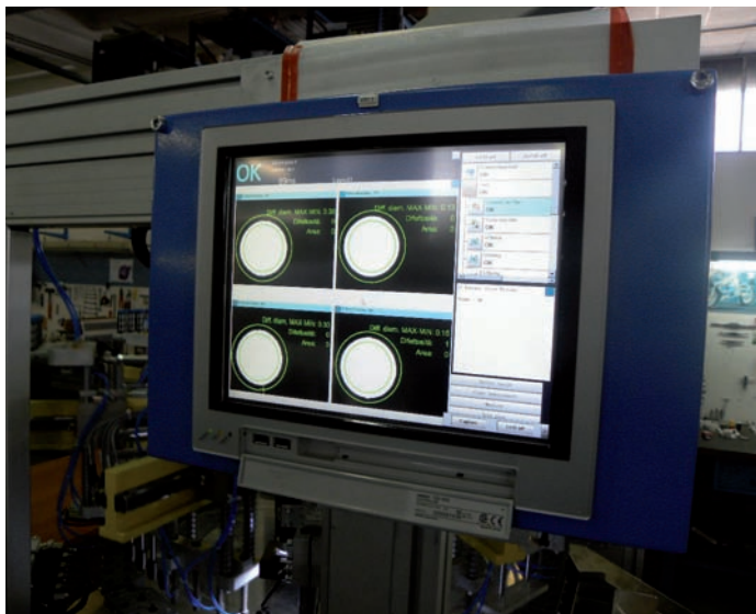
Controllo qualità. Tecmes equipaggia le proprie macchine con sistemi di visione.
