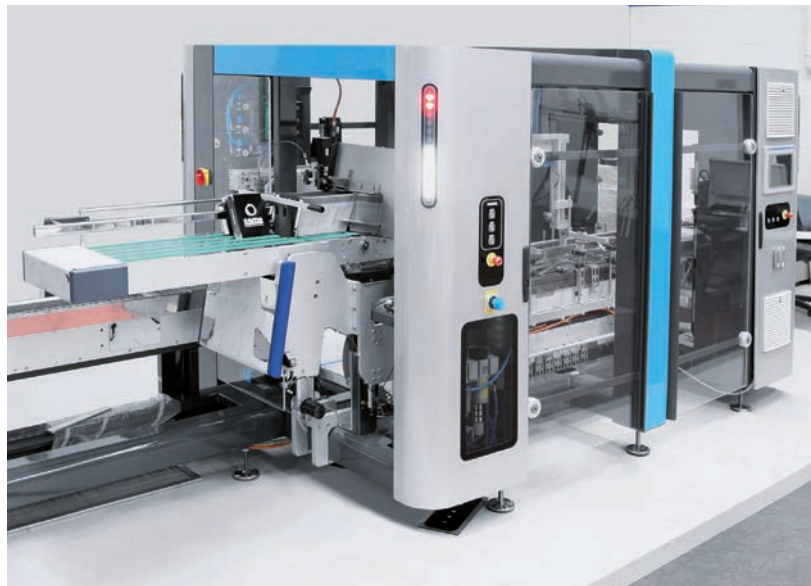
Minor numero di cavi e tubi: la soluzione con unità di valvole CPX/MPA riduce tempi e spazio di installazione di circa un terzo.
