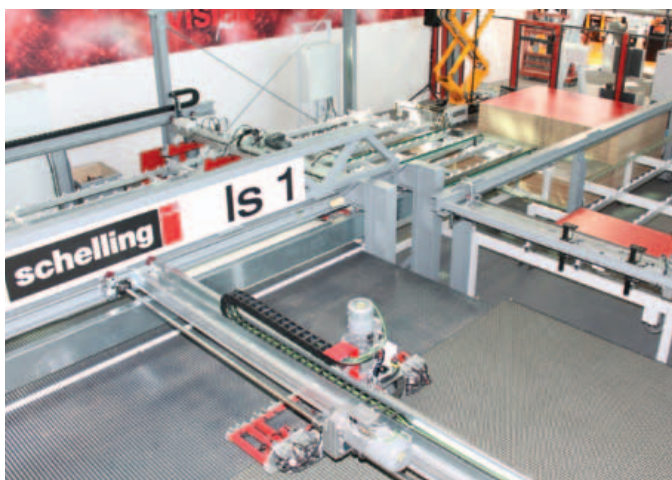
Grazie alle sue caratteristiche innovative, Schelling 'IS 1' consente il taglio multiplo dei pannelli.
