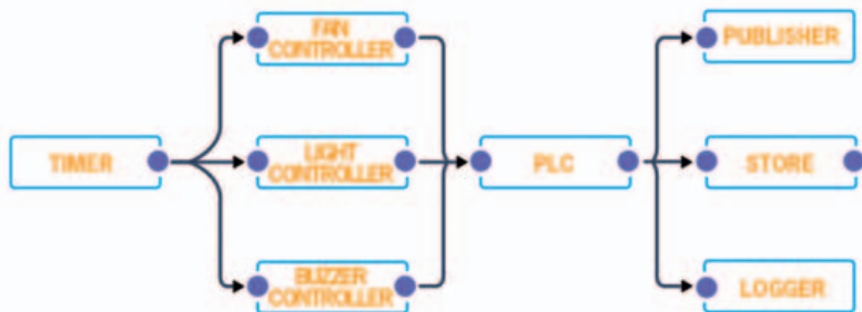
Un esempio di applicazione IoT costruita con la funzione Wires di ESF.
