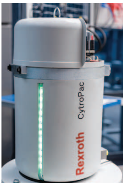
L'unità compatta CytroPac unisce un convertitore di frequenza al gruppo motore pompa e al sensore di pressione.
