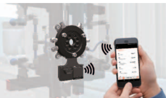
Gimatic ha inserito l'Rfid nelle mani di presa.
