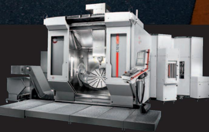
I centri di lavorazione Hermle sono maestri di microprecisione durevoli nel tempo. In cinque assi vengono lavorati pezzi fino a 2500 chilogrammi di peso – con una precisione di pochi micrometri. Per risultati perfetti.
