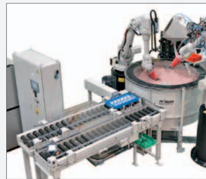
Surf Finisher Rösler: un trattamento efficiente e automatico di pezzi di precisione per intere superfici e aree specifiche.
