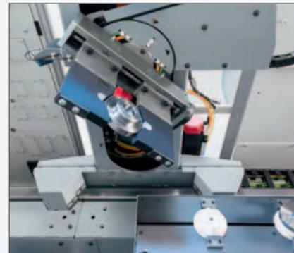
Con la serie VL i tempi di inattività vengono ridotti al minimo. Il sistema di automazione TrackMotion non solo provvede al trasporto dei particolari, ma viene anche utilizzato come unità di ribaltamento.
