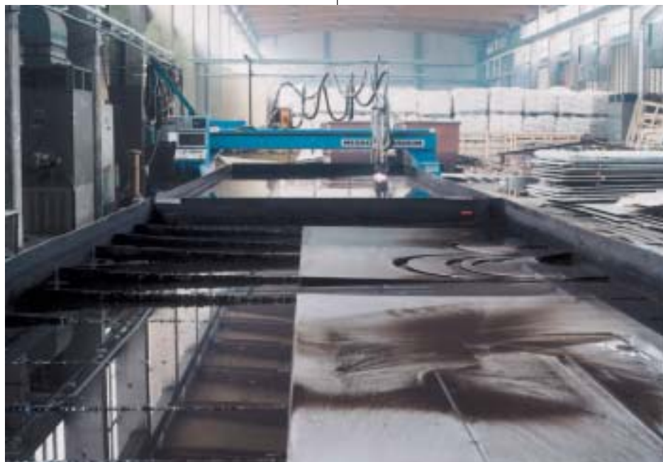
Figura 1. Taglio al plasma in acqua dell'acciaio al Cr-Ni (foto Messer).
