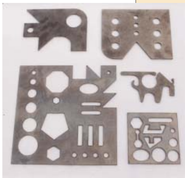
Figura 3. Campioni di taglio da lamiere di 2 mm con impianto HiFocus 100 (foto Kjellberg, Finsterwalde).
