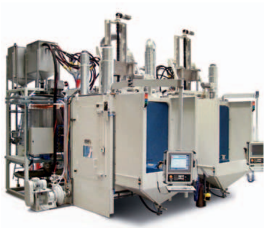
Il sistema Rösler di granigliatura a umido per la lavorazione di 14 diversi tipi di pale per turbina è in grado di soddisfare prestazioni elevate.
