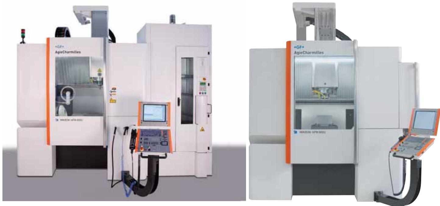
Il centro di lavoro Mikron HPM 800U, caratterizzato da compattezza e ampia area di lavoro. Le corse X-Y massime sono 800 mm x 800 mm. Sull'asse Z la luce è di 700 mm tra la superficie della tavola e il mandrino, ciò garantisce la lavorazione di pezzi voluminosi con utensili lunghi su tutti i cinque lati.
